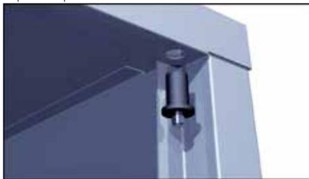
Надеть дверь соответствующим отверстием на ось с пластиковым наконечником. «Утопив» подпружиненный металлический наконечник верхней оси, завести дверь под верхнюю ось и совместить соответствующее отверстие в двери с осью до выщелкивания наконечника.
